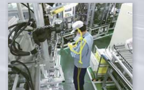
画像解析システムを用いた現場作業員のセンシング例
